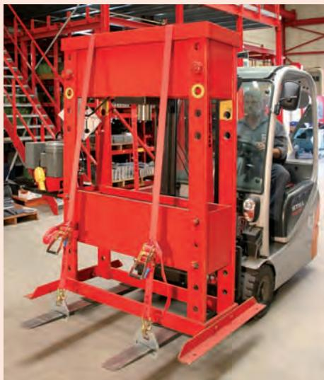
Фиксация груза с помощью захватов и ремней.
