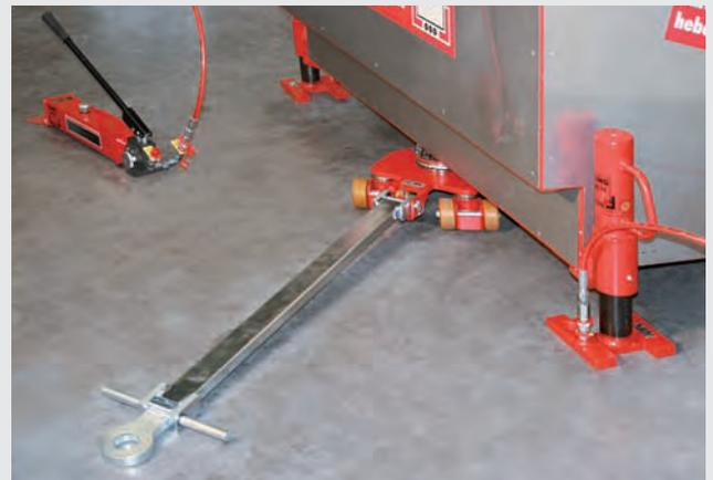
Применение в качестве управляемой тележки
