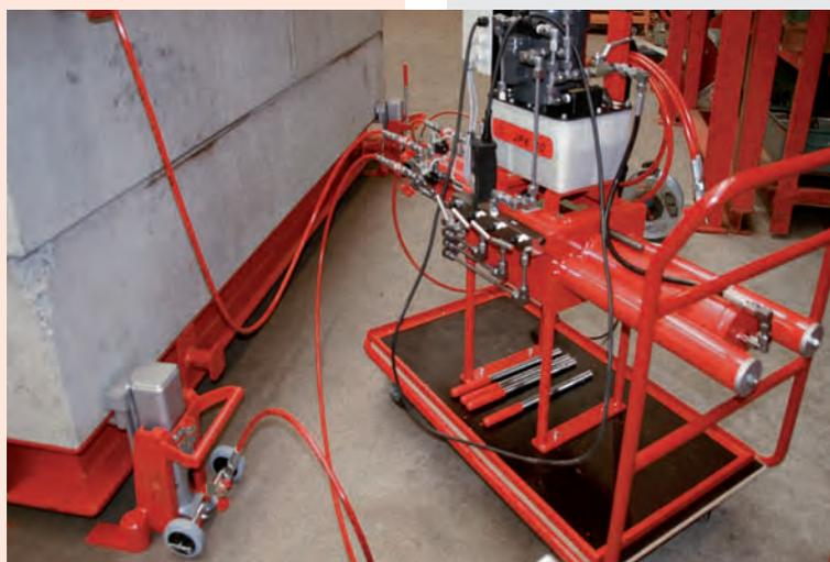
Гидростанция JD 40 E+ VS в работе
