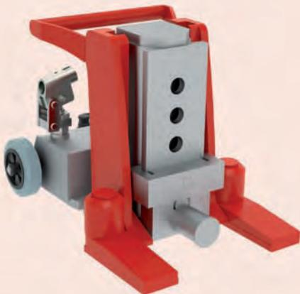
Гидравлический домкрат со специальным пальцем для контейнера: для безопасного подъема палец устанавливается в угол ISO контейнера. Доступная опция для всех гидравлических домкратов серии JH-G и JHS 10 ku.
