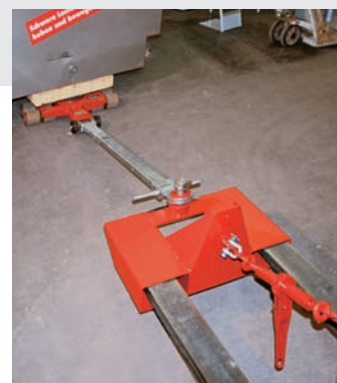
L'aide à la manœuvre JRH 3 en utilisation. De trekhaak voor heftrucklepels JRH 3 in actie.
