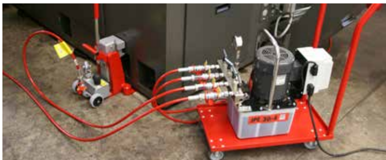
Elektropumpe JPE 30/4 NVR mit 4 Hebeegeräten im Einsatz
