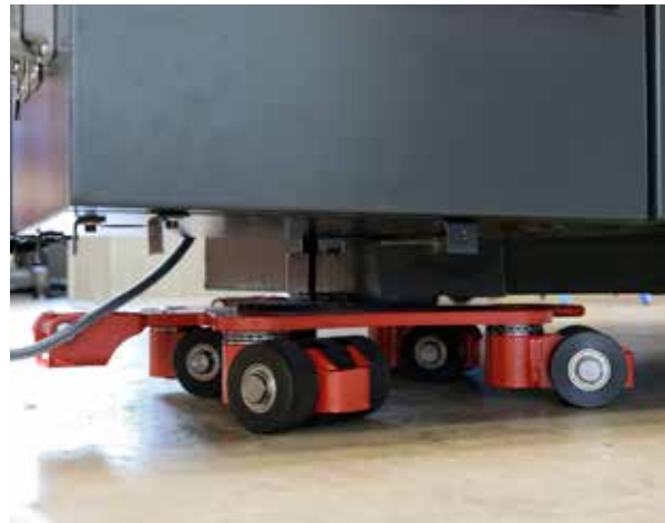
Kreiselfahrwerk JKB im Einsatz
