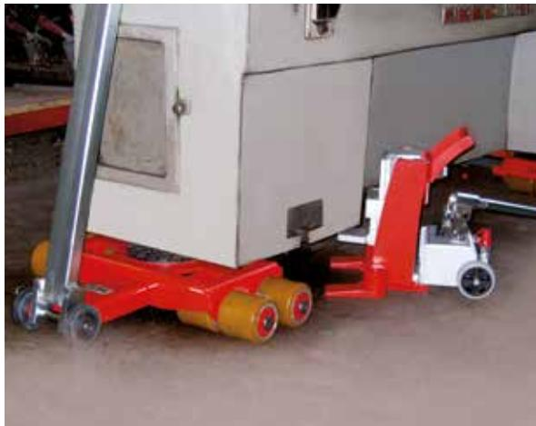
Kugelgelagerte Rollen garantieren einen leichten Lauf.
