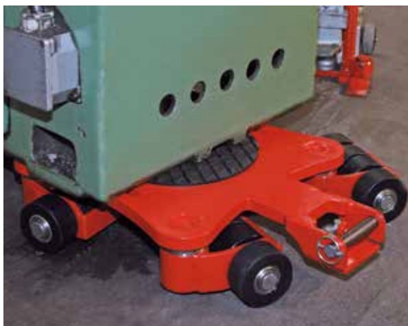
Kreiselfahrwerk JKB im Einsatz
