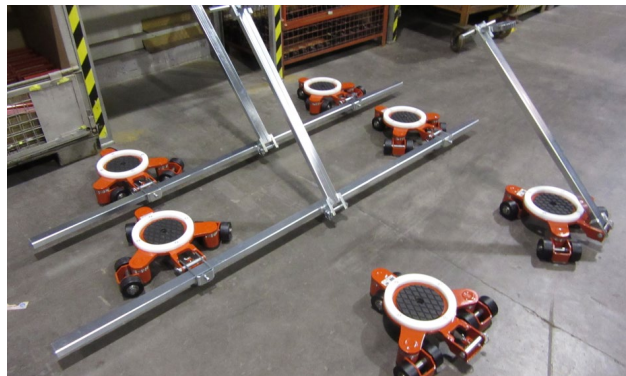
LKB 2K mit Aufnahmen für Maschinenfuß und Verbindungsstangen
