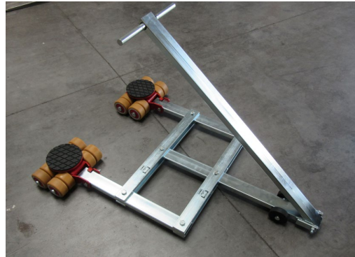
JTLB 6 K mit nach vorne verlegten Spurgestänge
