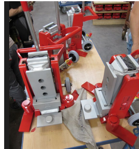
JH 15 EX mit Federrückzug, Sonderlasche mit Bolzen und form-schlüssiger Aufnahme an der Kopfplatte
